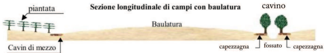
Fig. 22. Schema di sistemazione dei campi a baulatura
